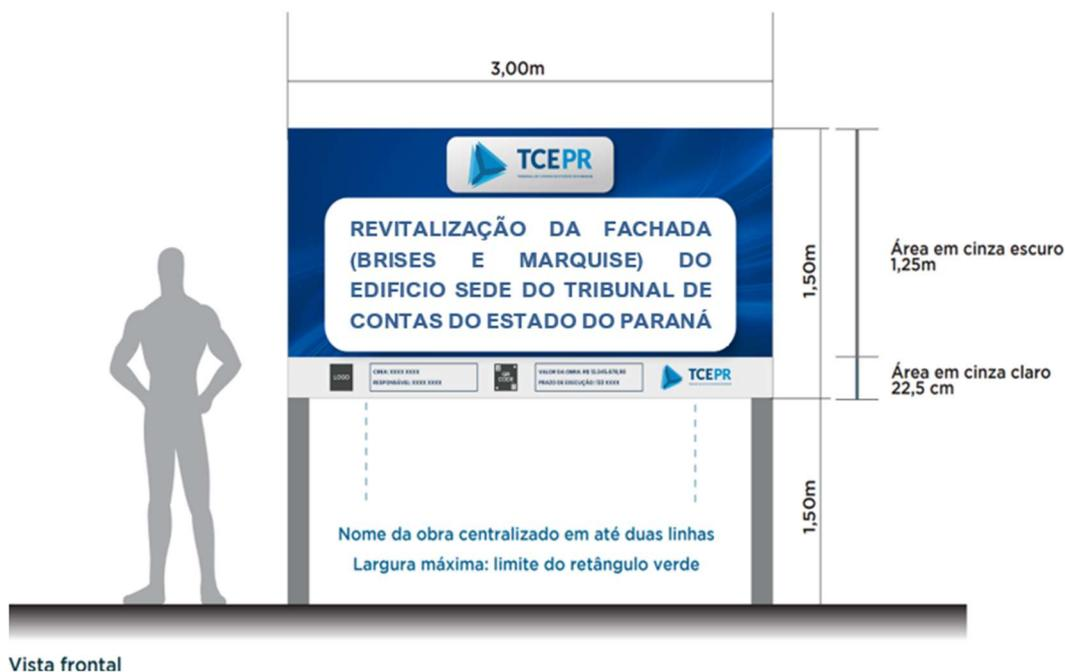
**Descrição Técnica:** A placa será confeccionada em material resistente, adequado para uso externo, garantindo durabilidade e legibilidade em condições climáticas adversas.
